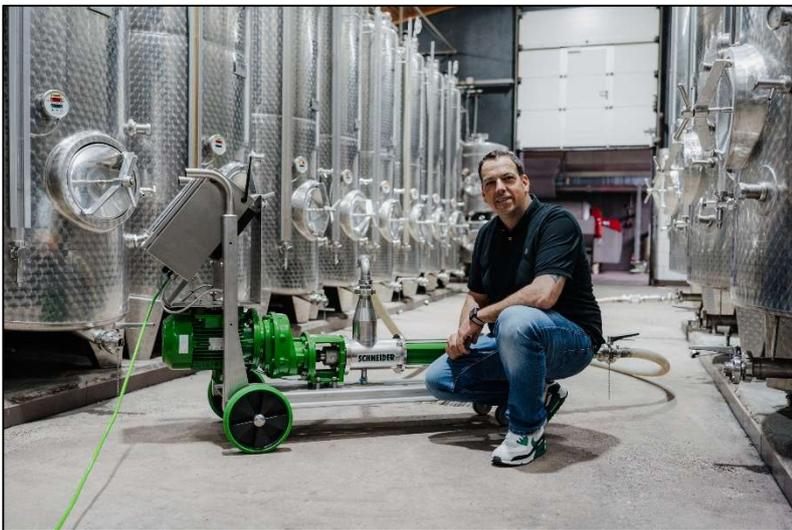
Mathias Beck mit der SCHNEIDER Vario Control, einer Exzentrerschneckenpumpe mit Drucksteuerung und Touch-Display
